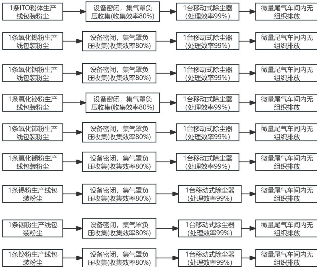
图 4.3-6 项目粉体包装废气收集、处理、排放示意图
